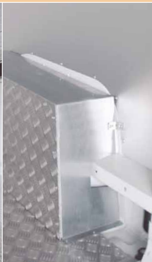
Passaruota in alluminio 30/10 Wheelhouse cover aluminium 30/10 Radkastenverkleidung aus Alu 30/10
